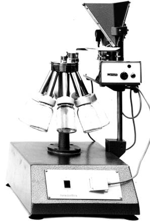
Abb. 8.5: Drehriffelteiler, Prototyp der Fa. Retsch, Schüttvolumen des Aufgabegutes etwa 1 l
