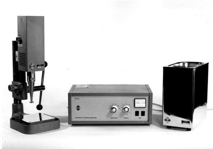
Abb. 8.7: Ultraschalleinrichtung mit Rüssel für die Nasssiebung und Wanne zur Siebreinigung
